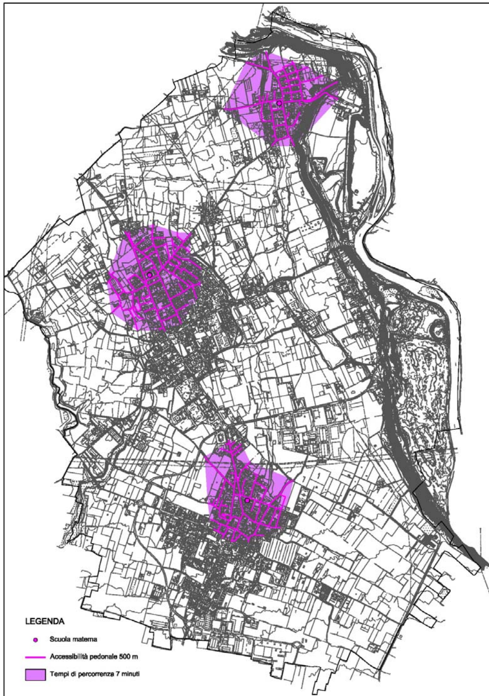
Figura 5 – Accessibilità pedonale alla Scuola elementare
