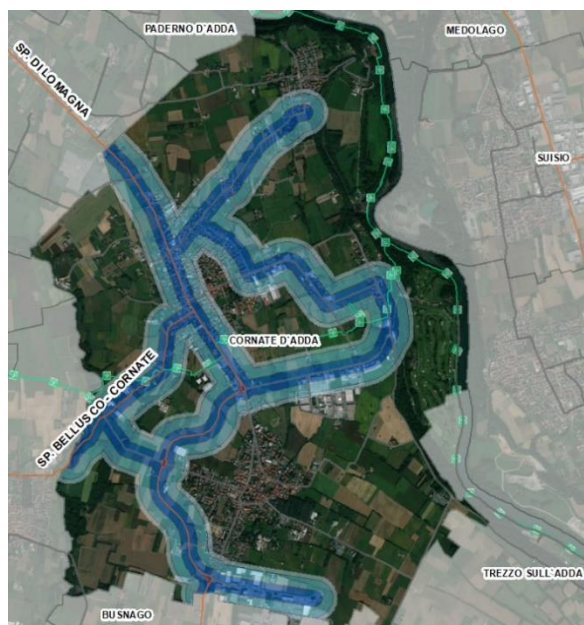
Carta degli involuipi delle aree di impatto conseguenti ad incidente a trasporto di sostanze pericolose scenario 2: “GPL”
